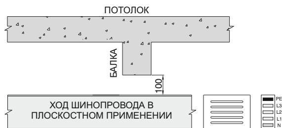
РИСУНОК 5 - ПЕРЕСЕЧЕНИЕ ПОД БАЛКОЙ А В ПЛОСКОСТНОМ ПРИМЕНЕНИИ
