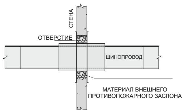
РИСУНОК 6 - ПРИМЕР ПЕРЕСЕЧЕНИЯ СТЕНА С ПРОТИВОПОЖАРНЫМ ЗАСЛОНОМ
