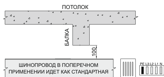
РИСУНОК 4 - ПЕРЕСЕЧЕНИЕ ПОД БАЛКОЙ А В ПОПЕРЕЧНОМ ПРИМЕНЕНИИ
